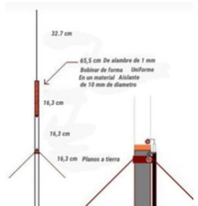
En la parte de la conexión del cable yo use un conector PL chasis pero si no contamos con un conector de este tipo se puede poner el cable directo a la antena como se muestra en la imagen, conectando la malla a los planos a tierra y el centro del cable al vivo de la antena.
